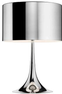
Tischleuchte mit diffusem Licht. Leuchtenkörper und Diffusor aus gedrehter Metallplatte, Diffusorhalterarme und Lampenfassungshalterung aus in den unten angegebenen Farben lackiertem Aluminiumlegierungsdruckguß. Die Diffusorhalterungen sind aus weißem, spritzgepreßtem Polycarbonat. Oberer Diffusorschirm aus sandstrahlbehandeltem Pressglas. Auf dem Kabel befindet sich der elektronische Dimmer, welcher eine schrittweise Einstellung der Lichtintensität.
